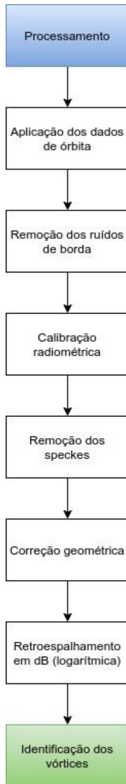
Figura 9: Etapas de pré-processamento das imagens SAR.
