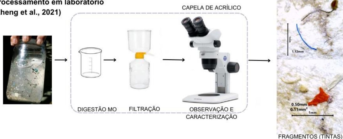
Figura 14. Representação gráfica do processamento de amostras de microplásticos em campo (superior) e em laboratório (inferior) seguindo a metodologia proposta por Zheng et al., [2021].
