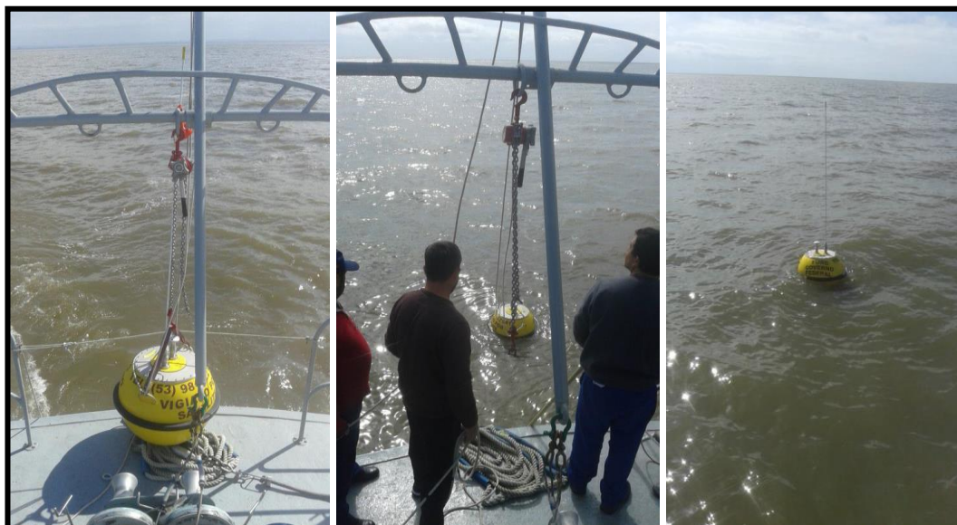
Figura 7: Fundeio do ondógrafo na Lagoa dos Patos.
